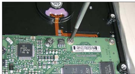
Bild 4: Ausbau der defekten Steuerplatine mit Torx-8-Schraubendreher.
