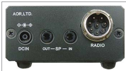
Bild 2: Das ARD9000 lässt sich ohne Eingriff ins Funkgerät über dessen Mikrofon- und Lautsprecherbuchse anschließen. Fotos: Werkfotos
