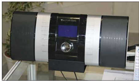
Bild 10: Ein Prototyp: Das Technisat Multyradio 1 empfängt DRM, DAB, UKW sowie analoge Lang-, Mittel- und Kurzwelle.
