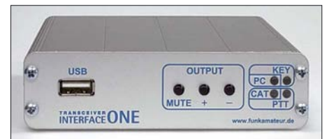
Bild 2: Das USB-Interface nach [15] deckt alle drei Arten der PC/TRX-Kopplung ab.
