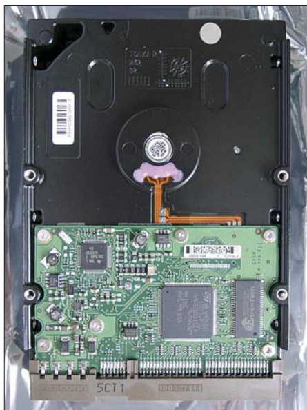
Bild 2: Ausgebaute Harddisk mit Steuerplatine
