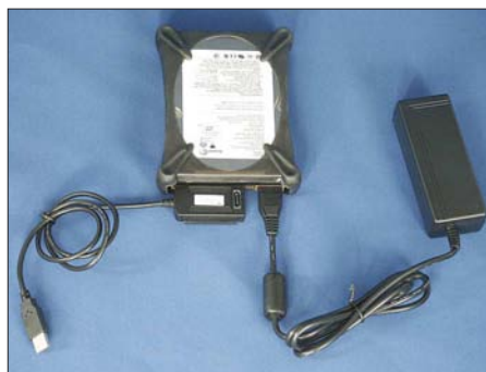
Bild 3: Anschluss einer Standard-3,5"-IDE-Festplatte mit übergezogenem Silikonumhüllung an USB-Adapter und Netzteil: Fertig ist die preiswerte Speichererweiterung!
