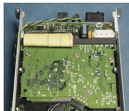
Bild 1: Ein Blick in eine industriell gefertigte externe USB-Festplatte fördert neben einer normalen IDE-Festplatte auch nur eine kleine Platine zutage, die zwischen den USB- und IDE-Schnittstellenpegeln und -protokollen umsetzt.
